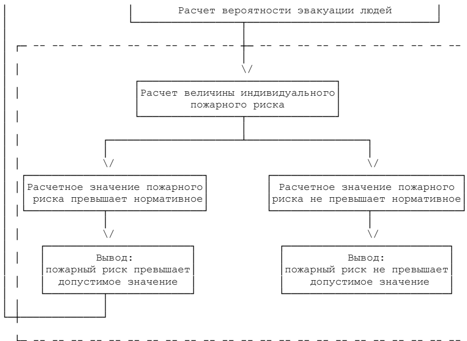
Рис. 1. Порядок проведения расчета индивидуального пожарного риска
